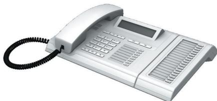
Modèle d'entrée de gamme pour postes de travail standards. Doté de 5 touches de fonction fixes et de 8 touches de fonction programmables. Confortable grâce au mode mains-libres bidirectionnel simultané. Représenté ici avec OpenStage key module 15.
